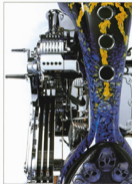
Optischer Lederblow: Kompressor und Primärtrieb
