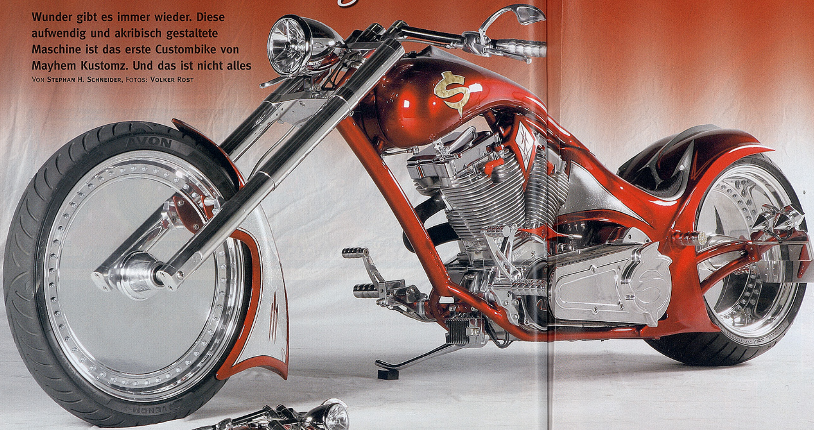
Die Six-Shot-Riser und das Rücklicht-Element mit seitlichem Kennzeichenhalter stammen von Choppers Inc. aus Florida
