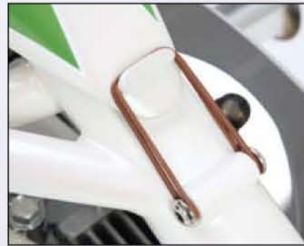
Kunst mit Tierhaut: Ledersitz von Custom Leather, Spannrriemen für die Tankbefestigung
