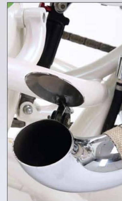
Truckerstyle: Die Klappe verhindert im Stand das Eindringen von Regen
