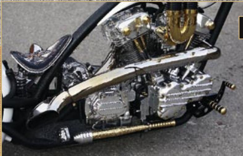
ben. Ebenfalls von BDL kommt die Schaltung, während gleichzeitig ein Dyna-6-Gang-Getriebe zum Einsatz gebracht wurde. Sekundär wird die Kraft des Big-Twin überaus konventionell und ultra-klassisch mittels einer Kette ans Ritzel weitergeleitet. "Voll geil", lautet Wolfis knappes Statement zum Leistungsverhalten des Powerpacks. "Das Bike läßt sich, wenn man sich darauf einstellt,
