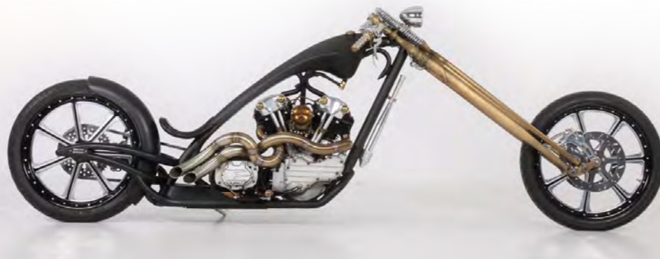
Goblin: ten bike powstał „wokół” silnika S&S wiernie naśladującego legendarnego harleyowskiego Knucklehead'a
